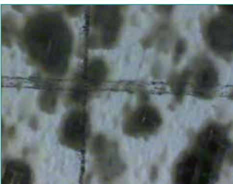
Membrana di filtrazione danneggiata da acqua/glicole inquinanti in un gasolio.
