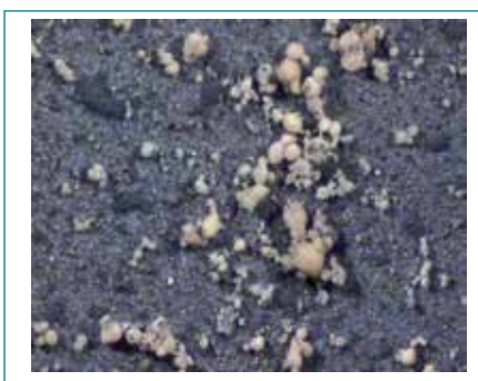
Sedimenti inquinanti di un gasolio con misurazione grandezza particelle.
